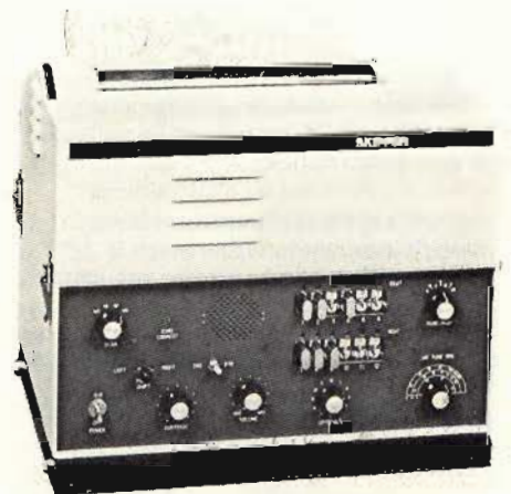
Fig. 6 - Un interessante e semplice ricevitore per fac-simile utile sia ai radioamatori che alla nautica da diporto. Si tratta del modello SKIPPER FR-10 per tutte le gamme delle onde corte (ELTAMAR Genova).
